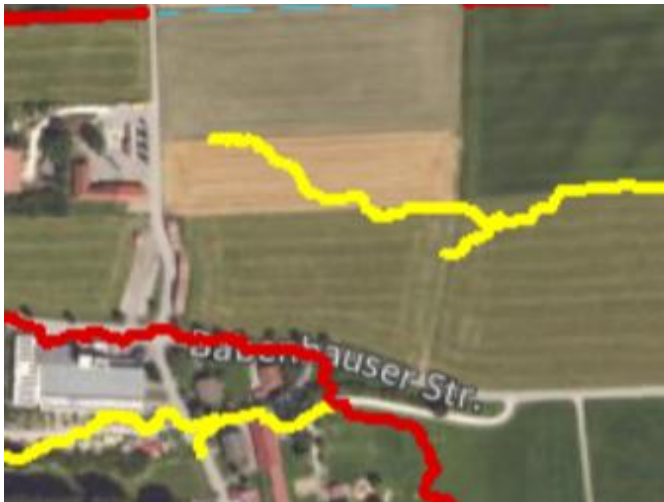
Abb. 4 Potentielle Fließwege bei Starkregen, gelb: mäßiger Abfluss, rot: starker Abfluss (Bayerisches Landesamt für Umwelt, 2025)
